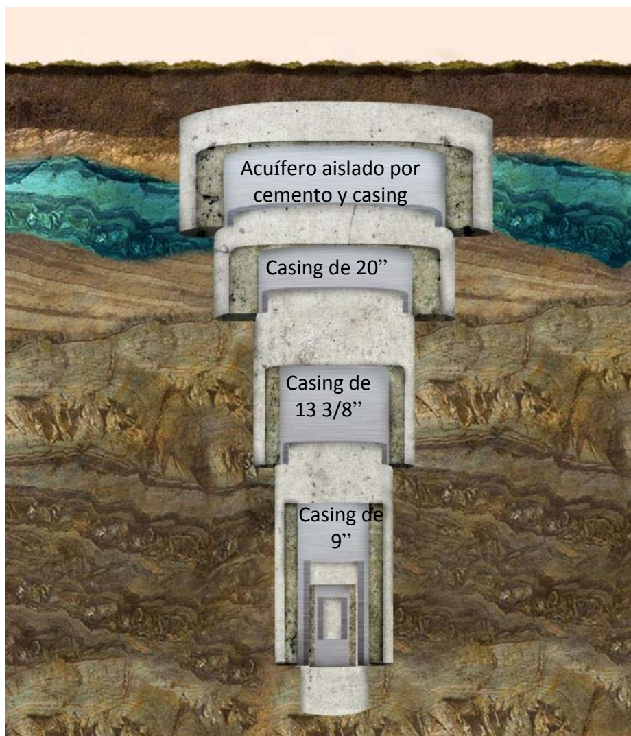
Casing de 5 1/2" en la formación. Imagen: YPF.
